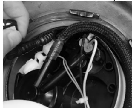
5. Rote la unidad para asegurarse de que la válvula de ventilación quede entre dos de los sujetadores laterales (no encima).
