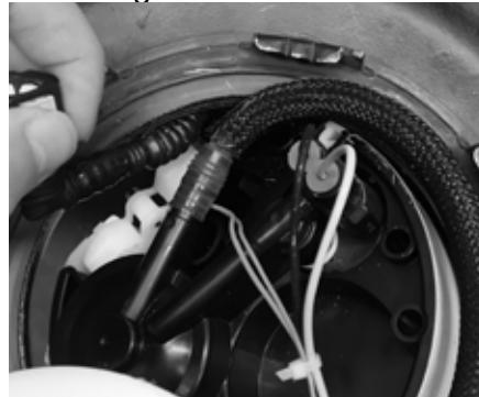
5. Faire pivoter la pièce pour vous assurer que la valve (ou soupape) de ventilation est positionnée entre deux des dispositifs de retenue latéraux (et non sur le dessus).
